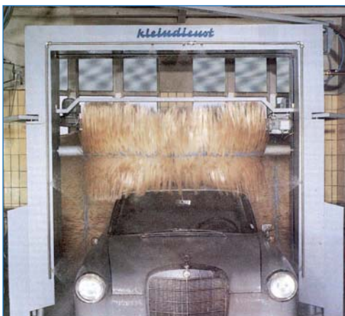
Kleindienst creó en 1963 su primer sistema de 3 cepillos, cuyo diseño básico sigue siendo actual.
